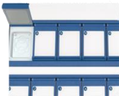
Obrázek 21.1 Optimalizační deska pro vytápění uvnitř zařízení komora vícekomorového IVF inkubátoru MIRI® II-12
