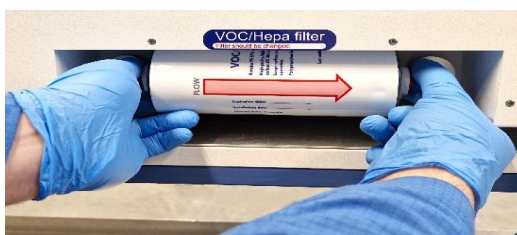
Obrázek 12.2 Postup vkládání a vyjímání filtru VOC/HEPA
