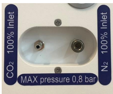
Obrázek 11.1 Vstupy pro plyny na zadní straně vícekomorového IVF inkubátorů MIRI® II-12
